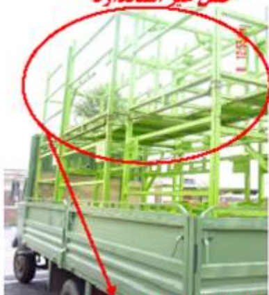
ارتفاع بیش از حد و عدم مهار بار
